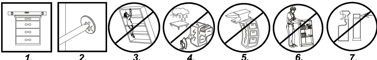
1. Wymagane jest wypoziomowanie i ustawienie mebli na równym podłożu.
