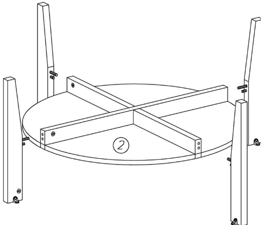
5. Каркас стола соединить с крышкой *1* так, чтобы дюбели стяжек и шканты вошли в соответствующие им отверстия. Затянуть эксцентрики, повернув их на 180 градусов. Зафиксировать полкодержатели с фиксацией AL02 Permo (уголки) на крышке саморезами 4,0x16
