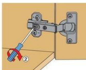
По завершении регулировки глубины двери затягивается винт.
