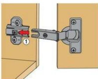
Боковая часть петли шлицем вводится под предварительно смонтированный винт монтажной планки и задвигается от себя.
