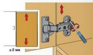
Слегка ослабить крепежные винты монтажной панели, выверить по высоте позицию двери.
