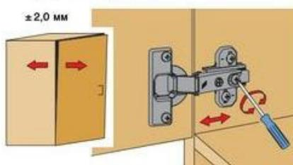
Ослабить крепежный винт и отрегулировать расстояние между дверью и боковой панелью шкафа.
