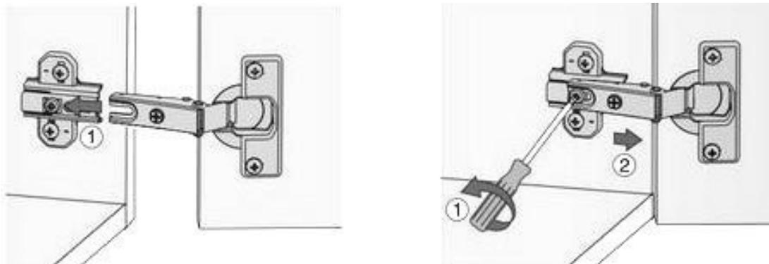
Боковая часть петли со шлицем вводится под предварительно смонтированный винт монтажной планки и задвигается от себя. По завершению регулировки глубины двери затягивается винт.
