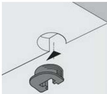
На стенках вертикальных **12, 13** в отверстия диаметром 15 мм вставить эксцентрики. На карнизе, выбранном для вашей композиции, в отверстия диаметром 5мм на профилях ввернуть дюбели DU 232. Установить карниз на стеллаж так, чтобы дюбели стяжек вошли в соответствующие им отверстия. Затянуть эксцентрики, повернув их на 180 градусов.
