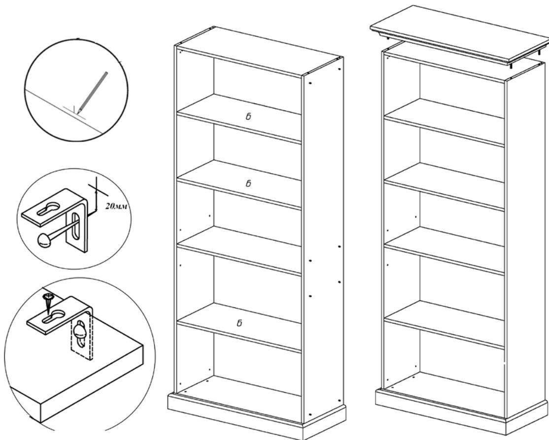
**ВАЖНО.** Шкаф необходимо фиксировать против опрокидывания с помощью двух подвесок и саморезов 4,2x13 с пресс-шайбой.
