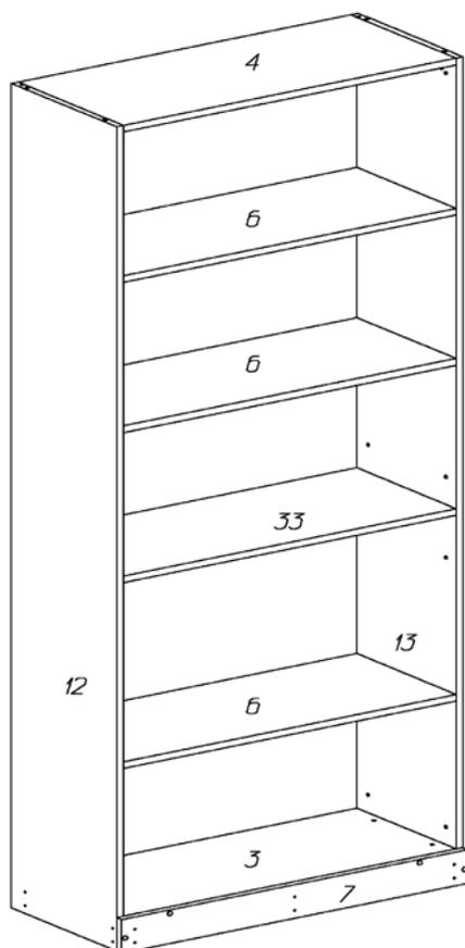
Если стеллаж будет примыкать к другим изделиям из серии, то на стенке вертикальной со стороны примыкания для межсекционной стяжки необходимо досверлить насквозь отверстия диаметром 5 мм и зенковать их для винта с потайной головкой.
