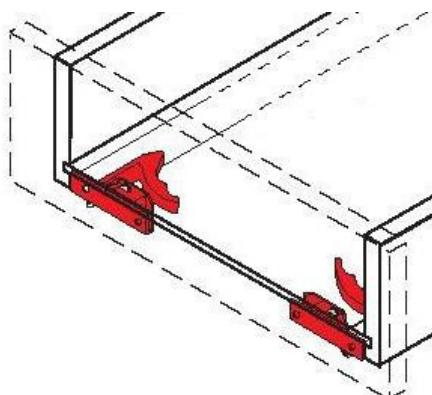
12. Выдвижной ящик установить на направляющие и подтолкнуть. Фиксатор автоматически фиксирует выдвижной ящик с направляющими Quadro, обеспечивая надежную плотную посадку.
